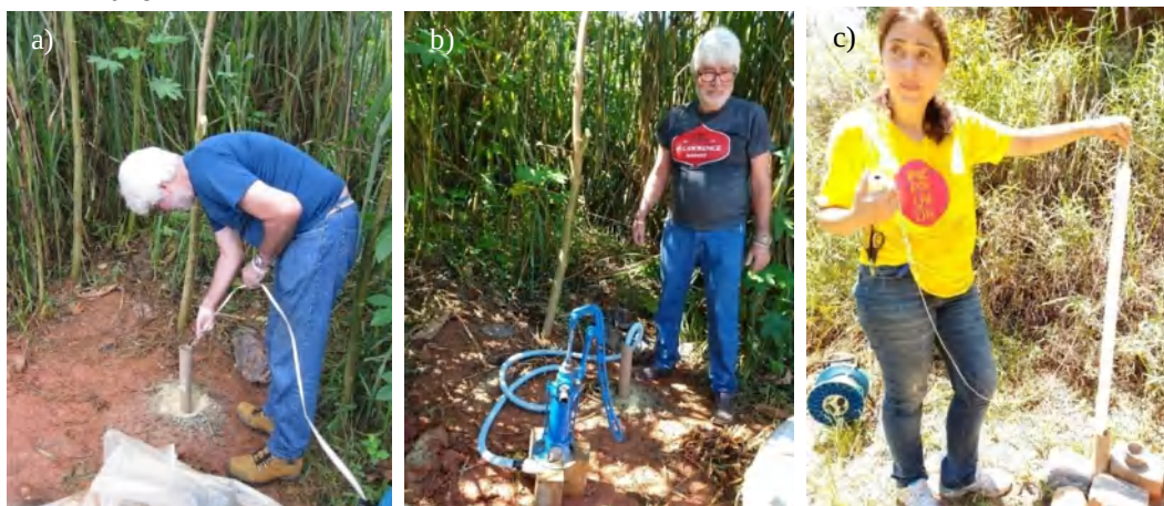
Figura 4-3 (a) Medição do Nível D'água, (b) Esgotamento do Poço, (c) Amostragem com Bailer
