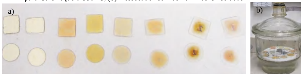
Figura 4-10 (a) Lâminas Circulares para Análise Natural e Glicolada, e Lâminas Quadradas para Calcinação a 550 °C, (b) Dessecador com as Lâminas Glicoladas
