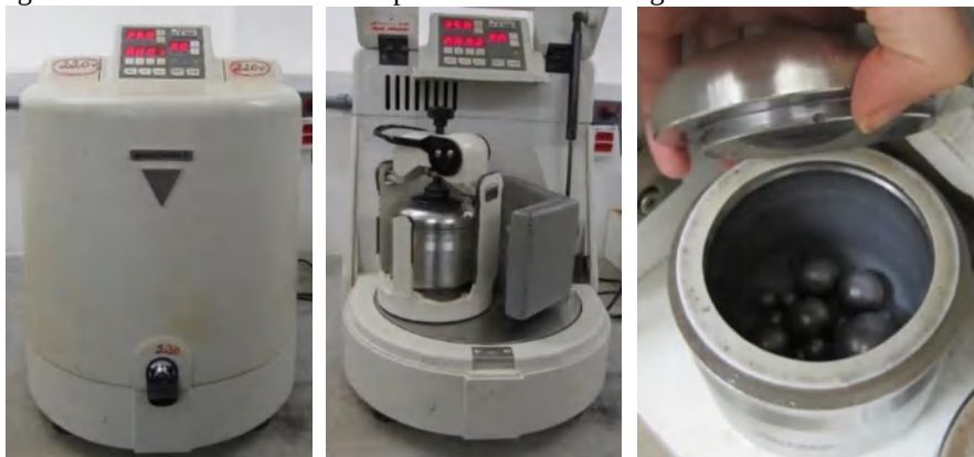
Figura 4-6 Pulverizador com Recipiente e Bolas de Tungstênio
