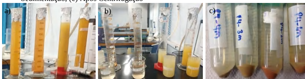
Figura 4-9 Separação da Fração Argila (a) Após Agitação, (b) Após 15 horas de Sedimentação, (c) Após Centrifugação
