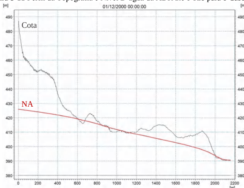
Figura 5-11 Perfil da Topografia e Nível D'água da ADR até o Rio para o Caso 2
